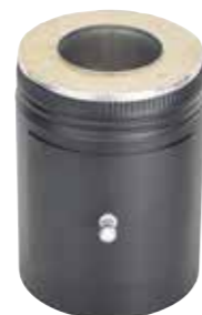
SPJELDMODUL Røykgasspjeld for å hindre kaldras. Yttermål: Ø 280 mm Byggelengde: 300 mm
