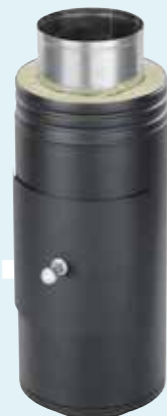
STARTMODUL SPJELD (halvisolert) Røykgasspjeld for å hindre kaldras. Yttermål Ø 226 mm Byggelengde 1000 mm 500 mm
